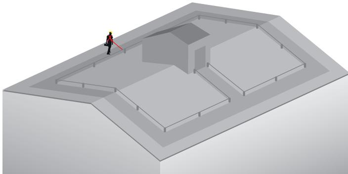
Un dispositif de retenue classique est situé à 2,3 m du périmètre du toit ou de tout bord ouvert à une chute potentielle. Le chemin de l'utilisateur est dicté.
