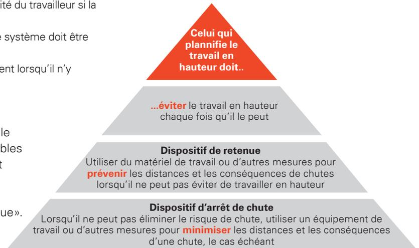
**Les systèmes de protection contre les chutes sont des systèmes de retenue ou d'arrêt de chute**
