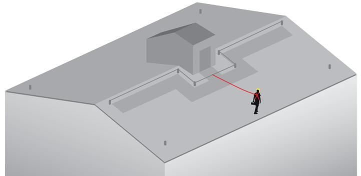
Un dispositif antichute nécessite davantage d'informations du point de vue de la conception; il doit toujours être étayé par des calculs publiés, applicables au type de substrat de toiture. D'autres facteurs tels que la hauteur du bâtiment et les dégagements de chute nécessitent une attention particulière.
