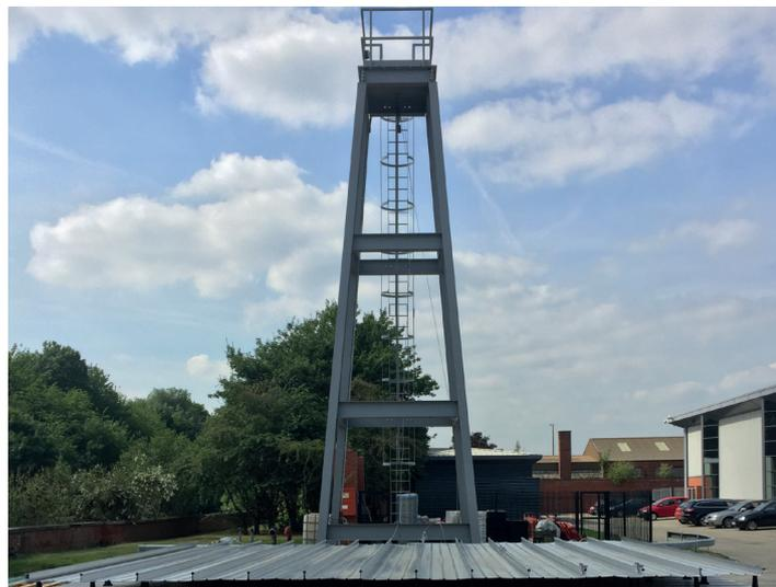
Banc d'essai et tour de chute
